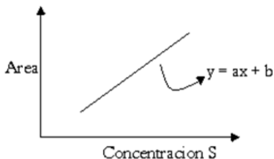
Figura N° 6. Curva de calibración para el cálculo del porcentaje de azufre
