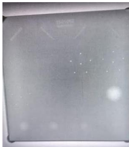
Imagen # 14: Montaje Experimental utilizado e imagen obtenida a partir de la irradiación del maniquí
