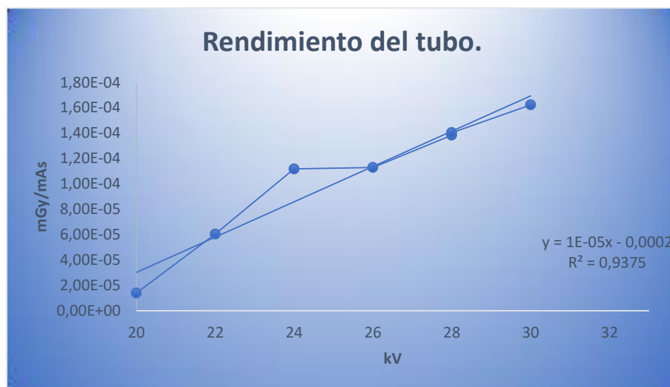
Imagen # 15: Gráfica del Rendimiento del Tubo de Rayos X del equipo de Mamografía
