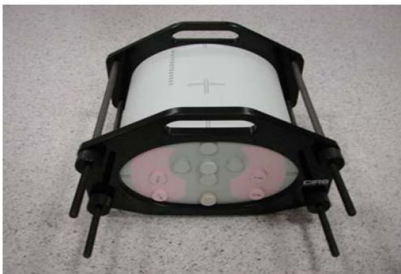
Figura 3-1. Maniquí CIRS modelo 002LFC, con forma de cilindro elíptico de diámetros 29 cm y 20 cm, y largo de 30 cm. Extraída de IAEA [9]
