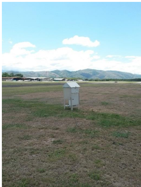
Figura 8: Muestreador de alto volumen (Hi – vol. Sampler) Marca General Metal Works (GMW) Grabes ubicado en el Aeropuerto Metropolitano de Caracas, Ocumare del Tuy estado Miranda. Del 09 de marzo hasta el 08 de abril del año 2017.
