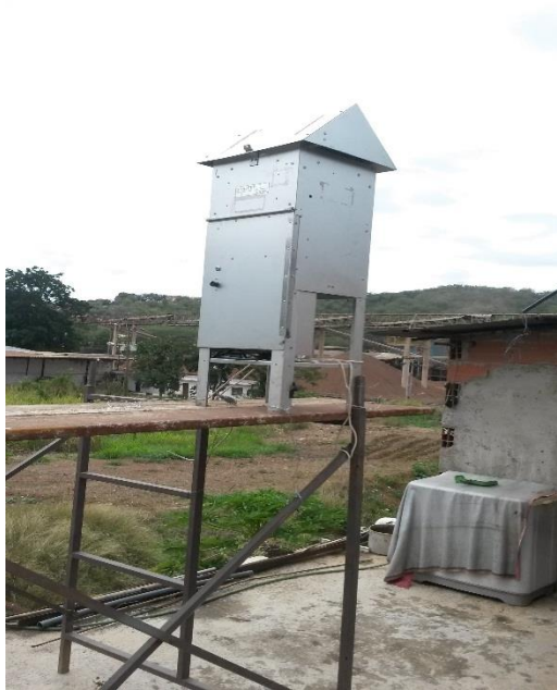
Figura 7: Muestreador de alto volumen (Hi-vol. Sampler) Marca General Metal Works (GMW), Grabesy, ubicado en Aliven, Charallave, estado Miranda. Del 09 de marzo hasta el 08 de abril del año 2017.
