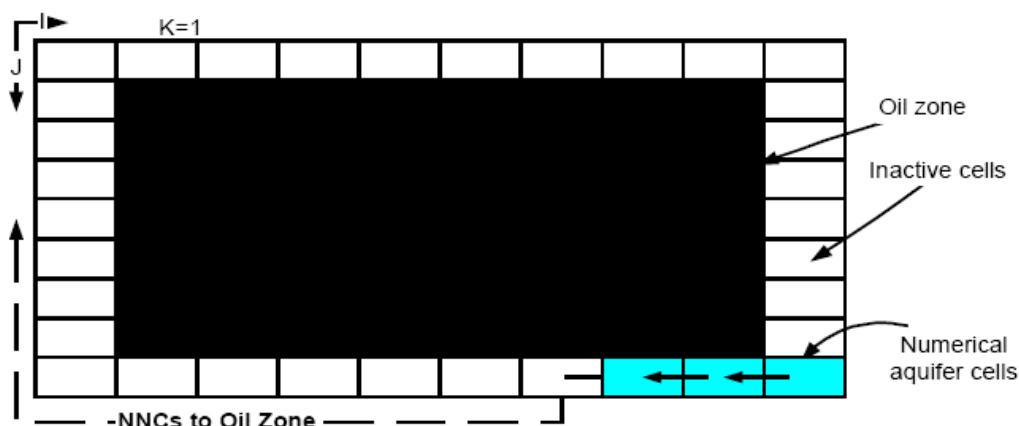
Fig. 2.4 Modello di acquifero numerico per geometria cartesiana
