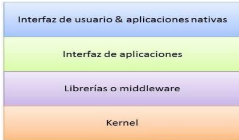
Figura 6. Estructura de un sistema operativo móvil (Android vs iOS, 2013)
