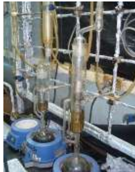
Figura 3. 9 Equipo de limpieza de muestras de roca basado en el proceso de destilación-extracción Dean-Stark
