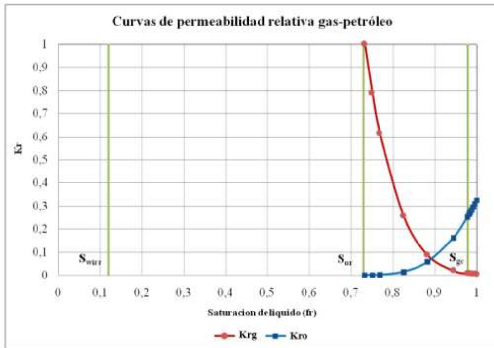
Figura 4. 12 Curvas de permeabilidad relativa gas-petróleo del experimento 3
