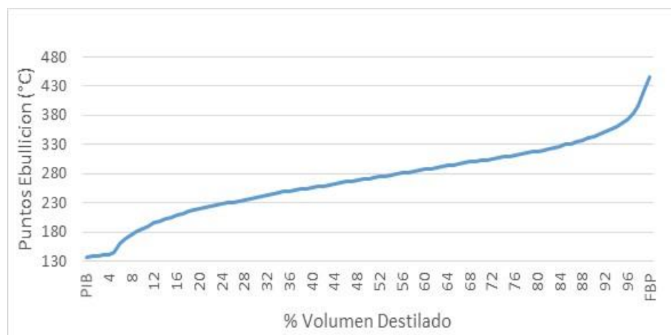
Figura. N° 17. Puntos de ebullición de diferentes componentes presentes en la fracción atmosférica obtenida.
