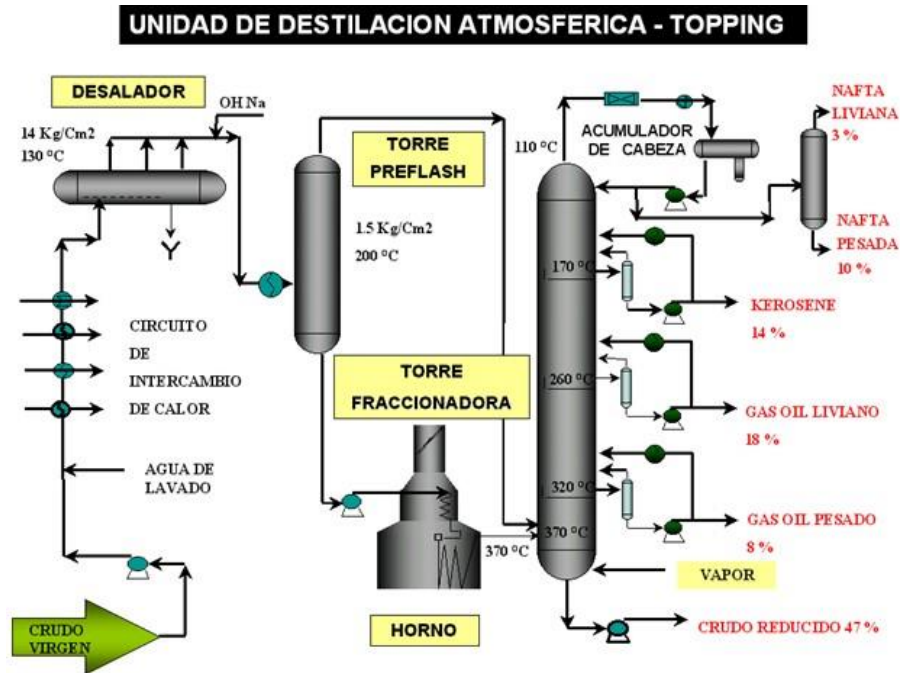
Figura N° 7. Diferentes procesos que se llevan a cabo en el proceso de destilación atmosférica [18]
