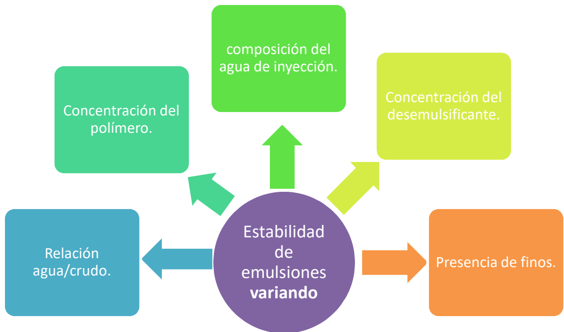
Figura 4.15. Esquema de las variaciones a realizar para estudiar la estabilidad de emulsiones.
