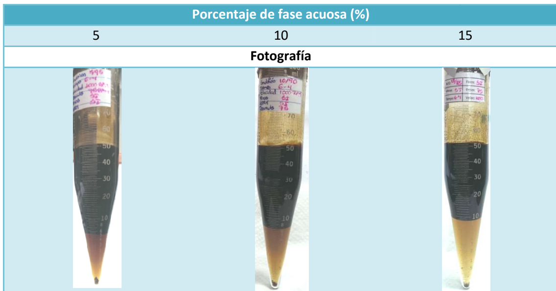
Figura 5.30. Vistas de las pruebas de botellas con contenido de finos a las 24 horas.
