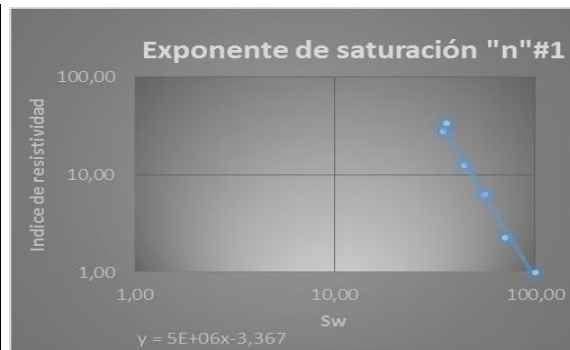
Figura. 30. Definición del parámetro “n” mediante medidas eléctricas.
