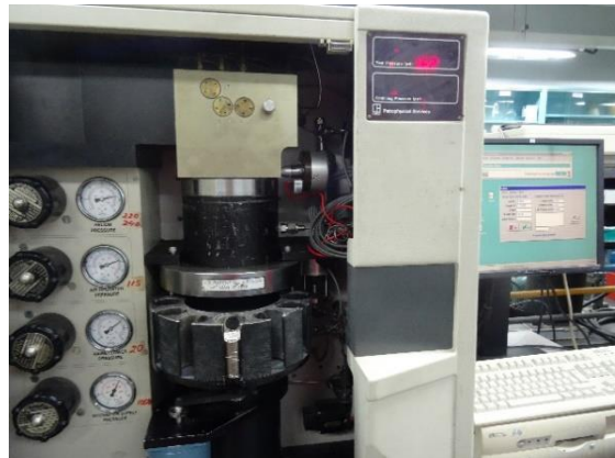
Figura B3. Mediciones convencionales en equipo CMS-300.
