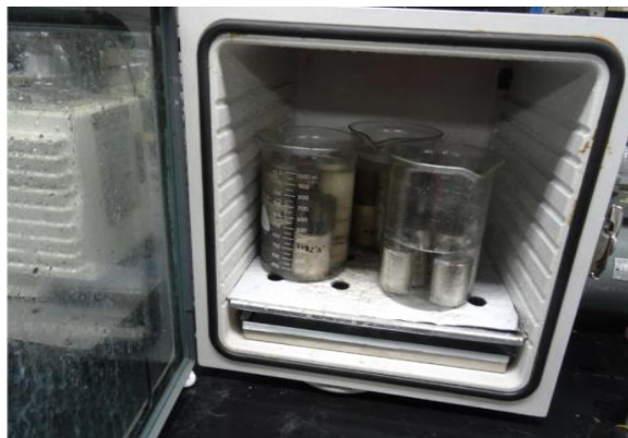
Figura B5. Saturación de la muestra en la bomba de vacío.
