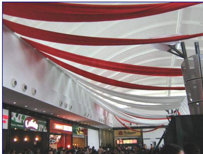
Imagen 7: Centro Comercial Orinokia, Montaje de cortinas para regular el sonido.
