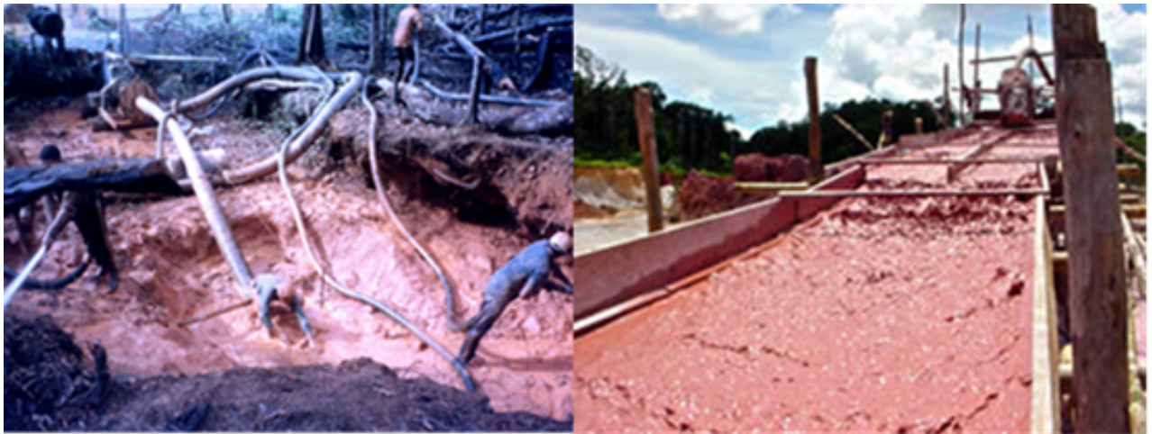
Figura 2.17. Fotografías de método de arranque y beneficio mineral, proyecto Bizkaitarra. Fuente: Matheus (2004).
