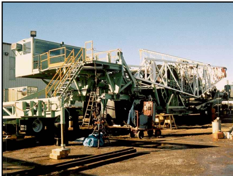
ANEXO 4. Trailers portantes de la cabria, planchada, carrito de tubería, unidad hidráulica y reservorio de aceite.
