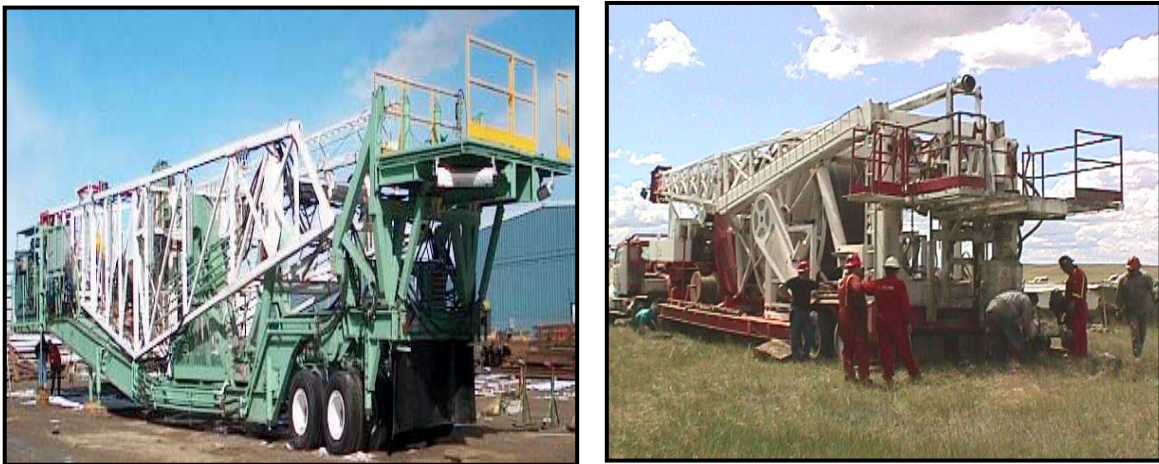
FIGURA 3.38. Equipos de las Unidades Multipropósito sobre LOW BOY.
