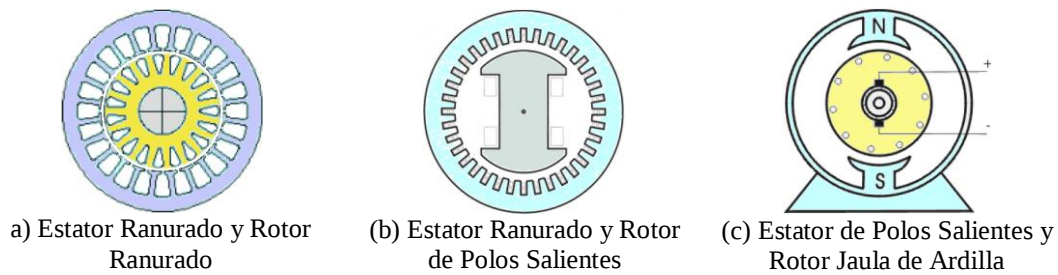
Figura 2. Estructuras clásicas de las máquinas eléctricas rotativas [Tomado y modificado de Maquinas Rotatorias “Juan A Tapia”].
