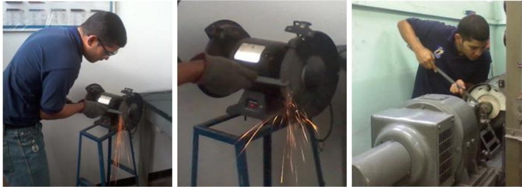
(a) (b) (c) Figura 33. Elaboración de barra para la calibración del torquímetro
