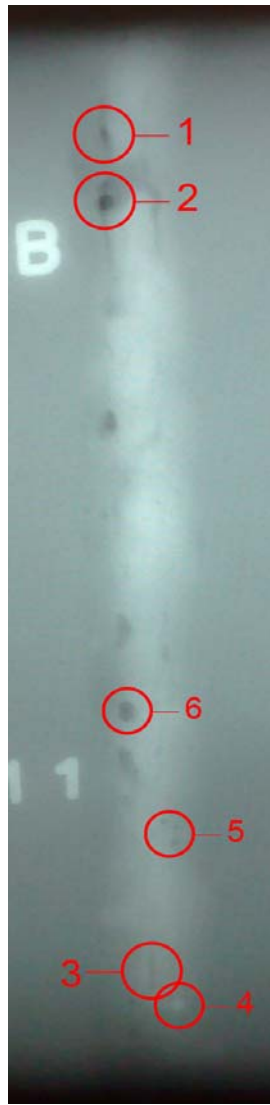
Foto 5: Placa radiográfica cordón de soldadura Probeta B
