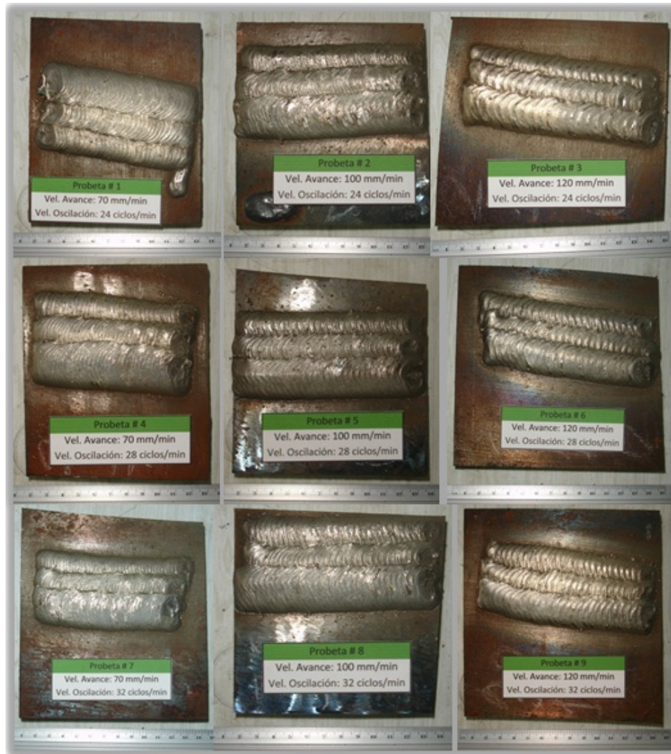
Figura 4.2 Muestreo de probetas con las distintas condiciones.
