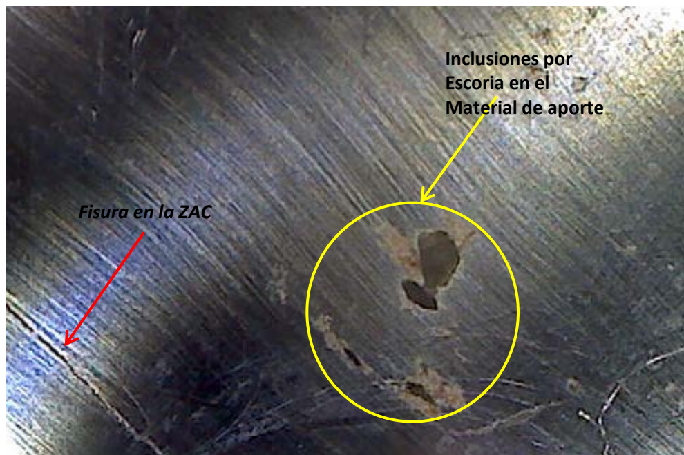
Figura 4.21 Probeta#7 zona cordón-ZAC 20x.
