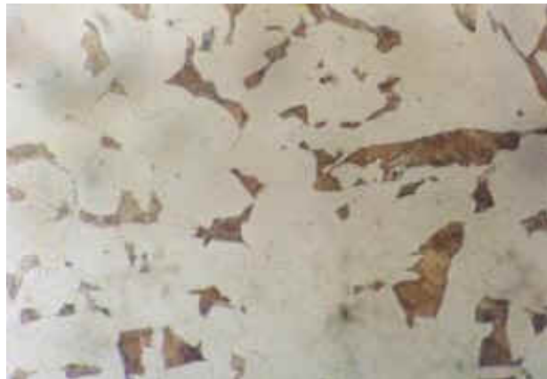
Figura 2.29 Microestructura de un Acero AISI 1015 Microatacado con Nital.
