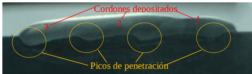
Figura 4.22 Forma de la penetración por movimiento oscilatorio.
