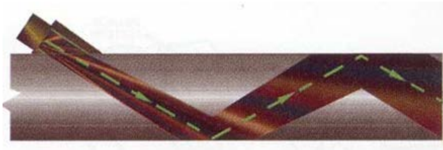
Figura 2.12 Propagación de un Haz en Angulo.
