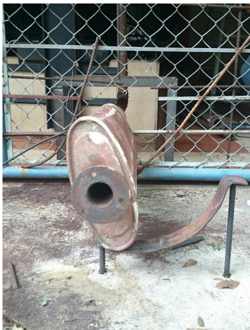
Figura A.6 “Silenciador en posición más baja de la base pivotante”
