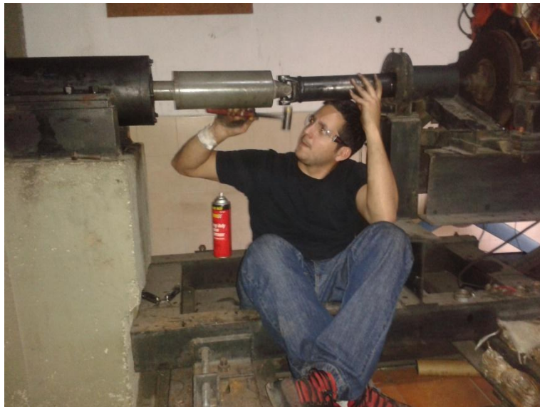
Figura A.17 “Instalación del cardan”
