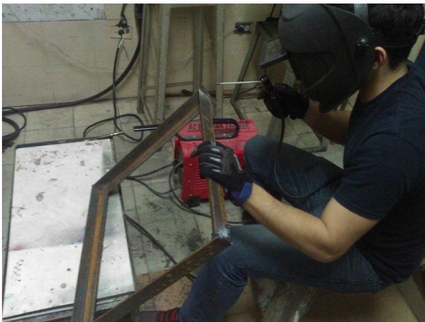
Figura A.12 “Soldadura por arco de la tarima”
