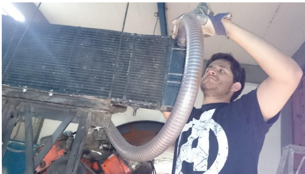
Figura A.13 “Instalación de las mangueras del radiador”
