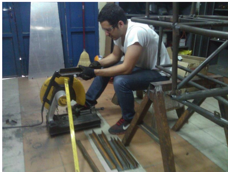
Figura A.11 “Proceso de cortado de los perfiles de la tarima”
