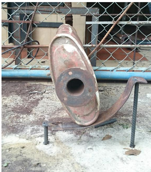
Figura A.7 “Silenciador en posición más alta de la base pivotante”
