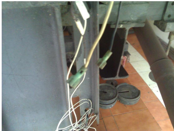
Figura A.9 “Conectores de fácil remoción del electroventilador”
