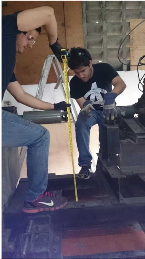
Figura A.16 “Medición de la altura del cardan”
