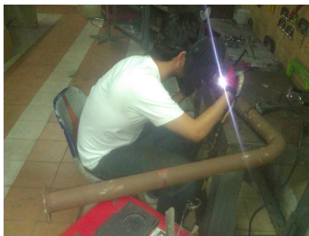
Figura A.3 “Soldadura TIG de las tuberías de escape”
