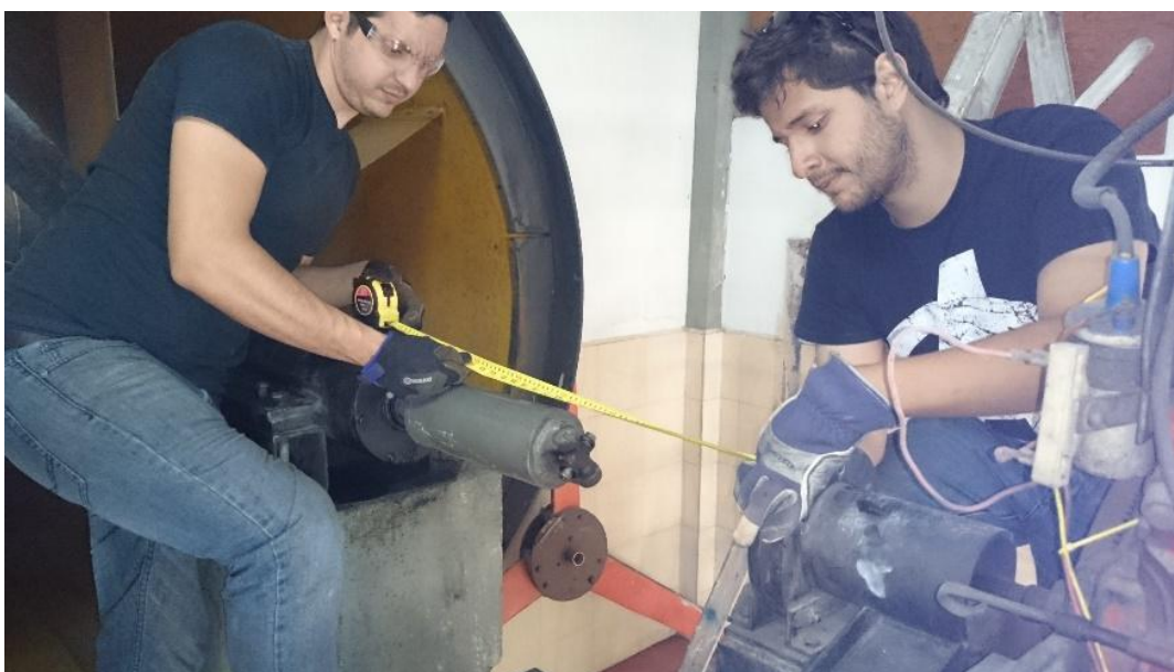
Figura A.15 “Medición de la longitud del cardan”
