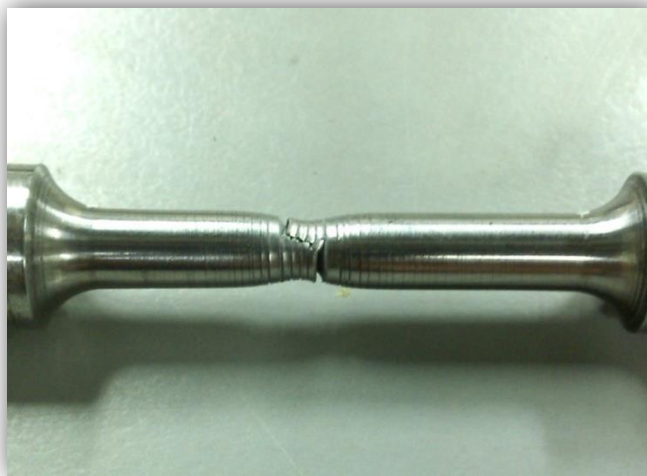
Fig. 4.3 Estriaciones en el cuello de las probetas de tracción
