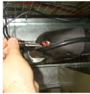
d) Medición de la temperatura del agua a la entrada del serpentín
