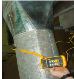
b) Medición de la temperatura de bulbo seco y humedo en el plano numero 2
