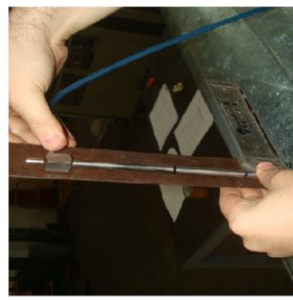
c) Medición de la temperatura ambiental de bulbo seco y humedo
