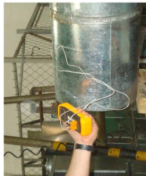
a) Medición de la temperatura de bulbo seco y humedo en el plano numero 3
