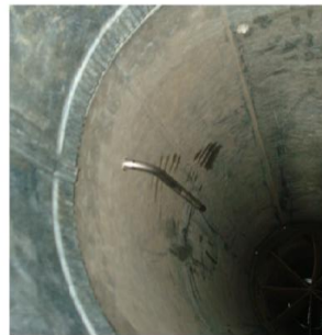
d) Medición de la temperatura del agua a la entrada del serpentín
