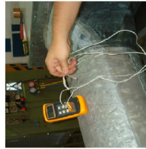
c) Medición de la temperatura ambiental de bulbo seco y humedo
