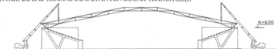
FIG. 28 MONTAJE DE LAS TRAMAS DE II ETAPA EN LUGAR TRANSITORIO
