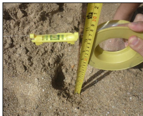
Fotografía 12. Medición de la altura de berma con metro y colocación de nivel para construir el perfil
