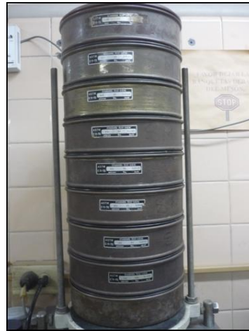
Fotografía 18. Batería de tamices listos para iniciar la agitación.
