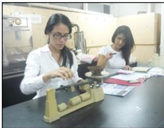
Fotografía 21. Mediciones de peso de acuerdo a la variación granulométrica de las arenas muestreadas.
