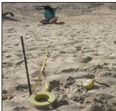
Fotografía 11. Hincado de jalón para nivelación con cordel y medición con cinta métrica.
