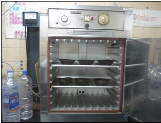
Fotografía 17. Estufa modelo Memmert empleada para el secado de las muestras
