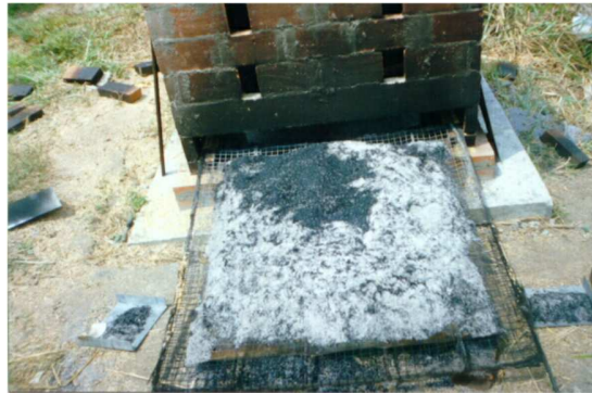
Figura 3: Ceniza de cascarilla de arroz a la salida del horno
