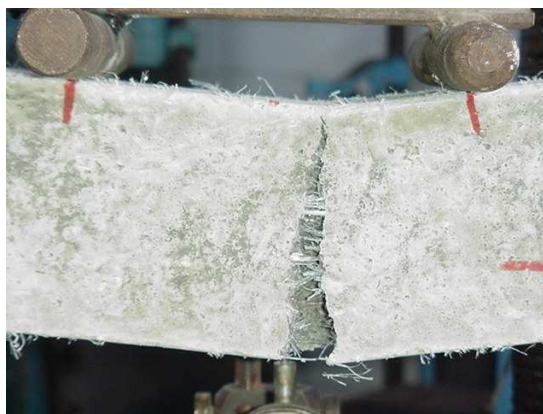
Figura 6: Probeta de mortero reforzado con fibras de Sisal ensayado a la flexión
