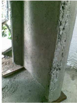
Figura 1: Componente de mortero reforzado con mallas de plástico
