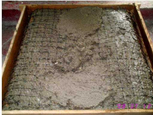
Figura 7: Panel de mortero reforzado con mallas de plástico
