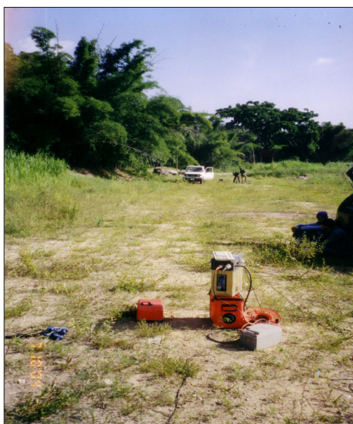
Figura 3.9. Izquierda: realización del perfil sísmico F01. Derecha: Golpes de mandarina empleados como fuente.
