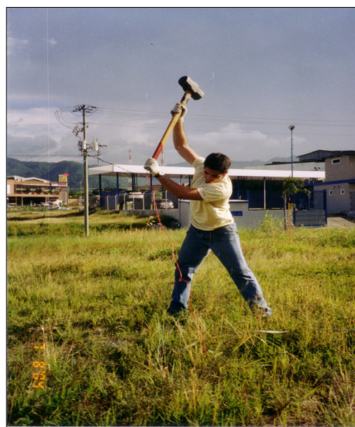
Figura 3.9. Izquierda: realización del perfil sísmico F01. Derecha: Golpes de mandarina empleados como fuente.
