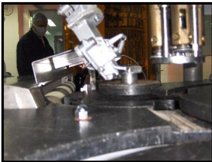
Figura 74 Vista de Colocadora de Tapas instalada en la Línea de Jarabes en Laboratorios Vargas
