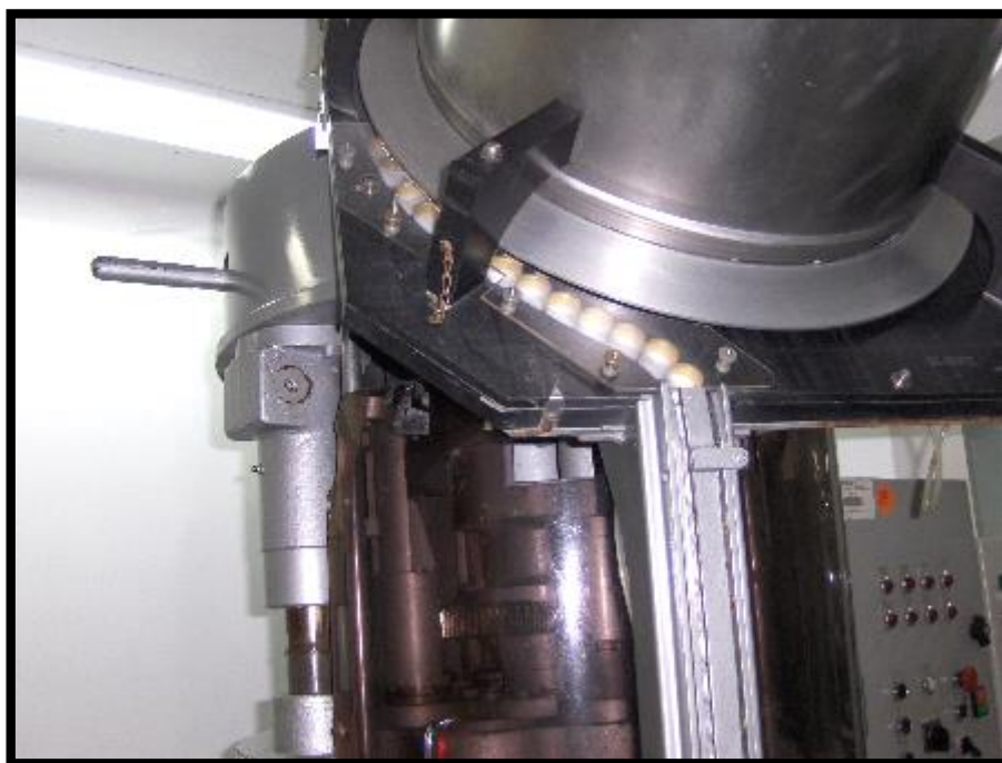
Figura 75 Vista del riel de la Colocadora de Tapas instalada en la Línea de Jarabes en Laboratorios Vargas.
