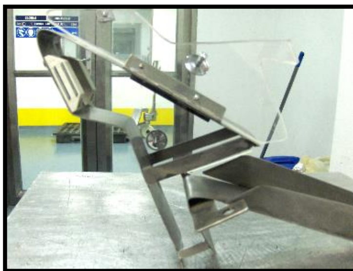
Figura 88 Vista en ángulo de dispositivo ordenador de envases tras expulsión del plato, con compuerta abierta.
