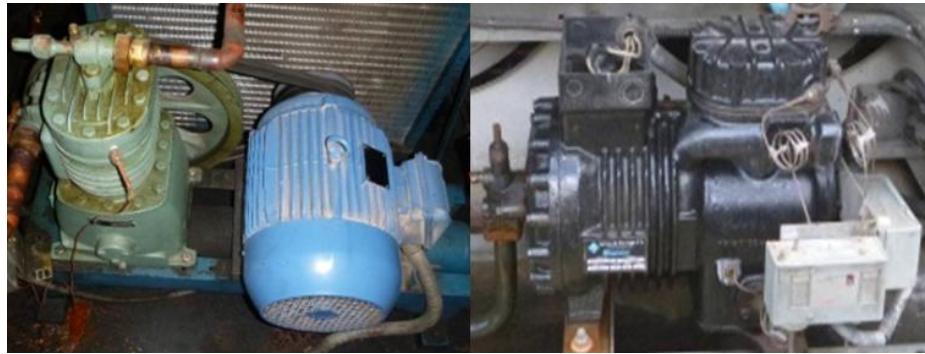
Figura 2.7: Compresor abierto (izq.) y compresor semi-hermético (der.).
