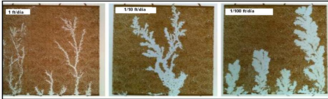
Figura 15. Experimentos en micromodelos mostrando el efecto de la tasa de flujo sobre el comportamiento en el adedamiento a una relación de viscosidad constante de 10000 mPa.S (Doorwar, S et al. 2015). Unidades 1 ft = 0,3048 m.
