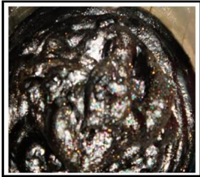
Figura 4. Producción de crudo espumoso a la salida de un núcleo Li (2012)
