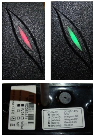
Figura 8- Lector en estado de espera (izquierda), autorizado (derecha) y beeper (abajo)
