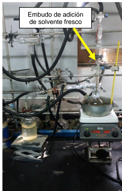
Figura 9. Montaje de deshidratación por destilación de la solución de d,l-lactida y glicolida en m -xileno.
