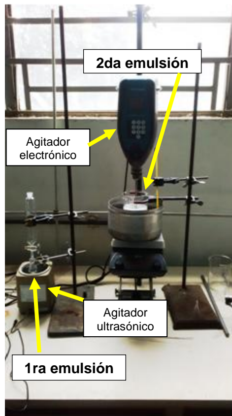
Figura 14. Montaje general de la preparación de las microcápsulas en presencia de fármaco Cx.
