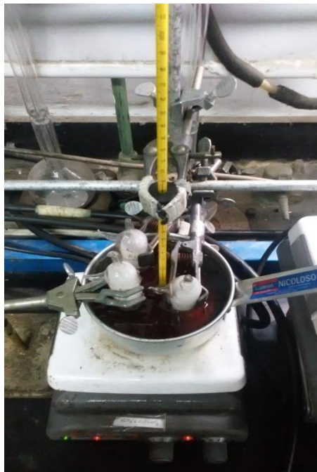
Figura 12. Ampollas selladas con monómeros en su interior, sumergidas en baño térmico en el proceso de calentamiento.
