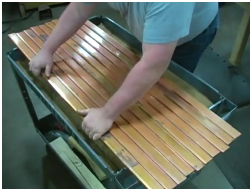
Figura 3.10. Barras de cobre del rotor.
