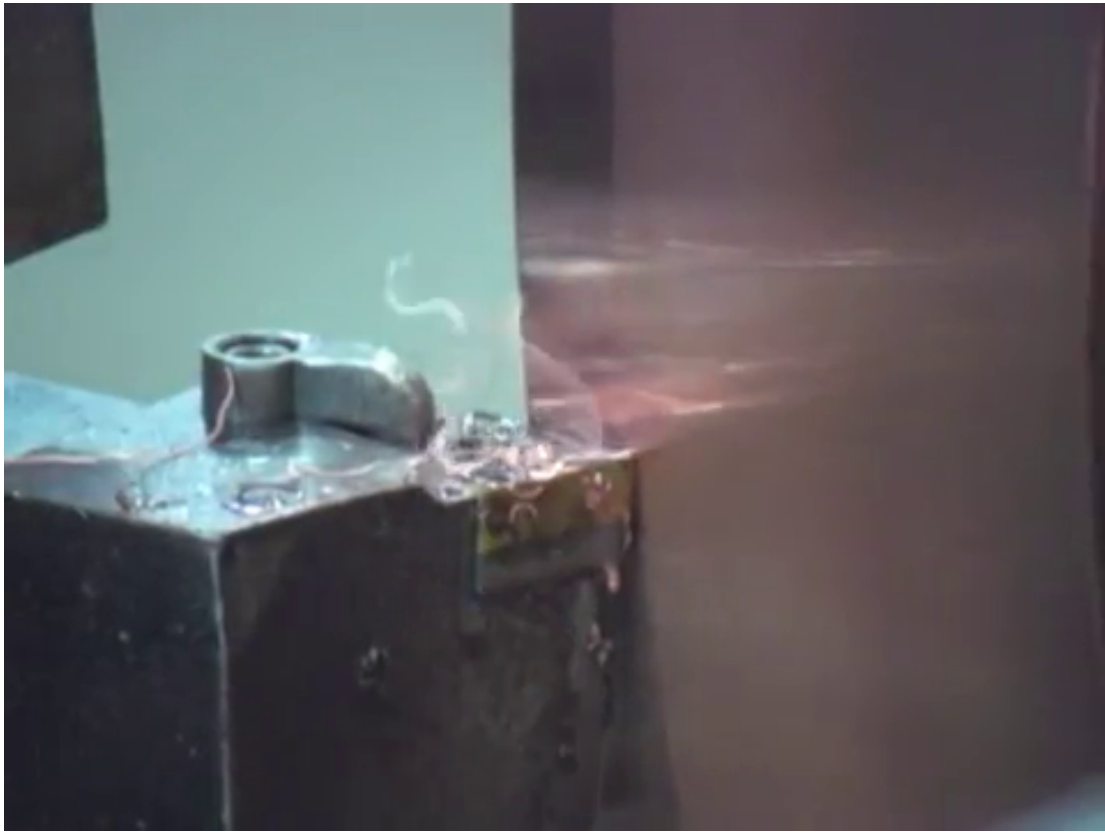
Figura 3.26. Rectificación de las barras del rotor.
