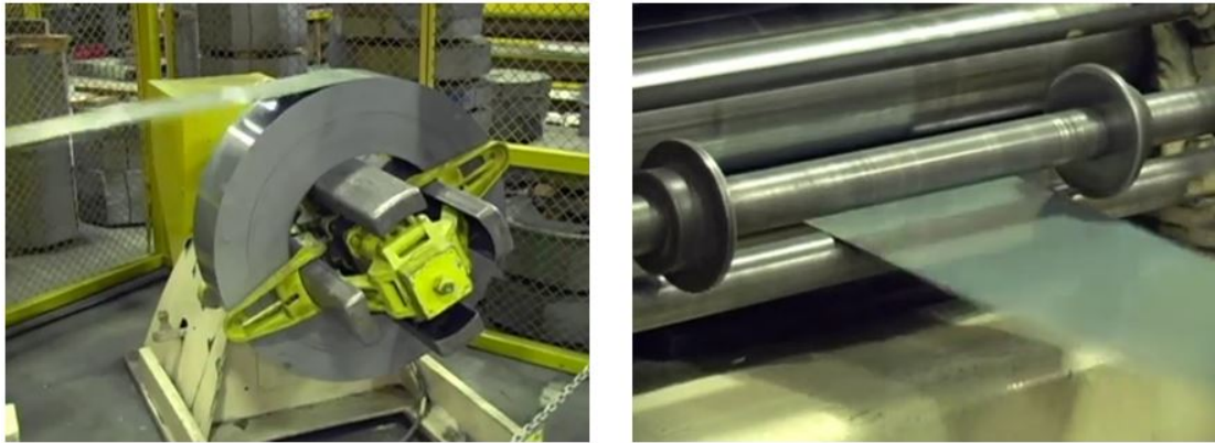
Figura 3.18. Laminas para ser cortadas del rotor y estator.
