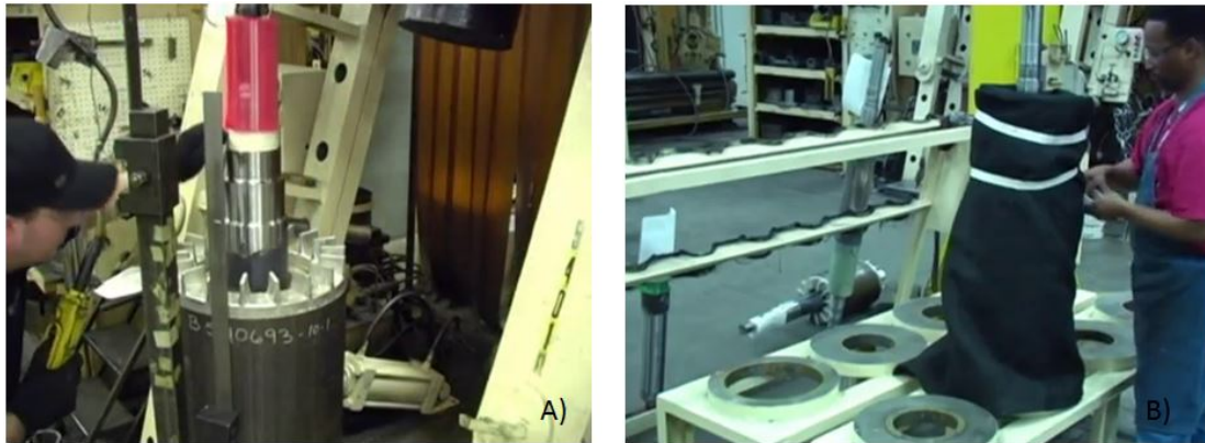
Figura 3.23. A) Rectificación del orificio del rotor B) Enfriamiento del rotor.
