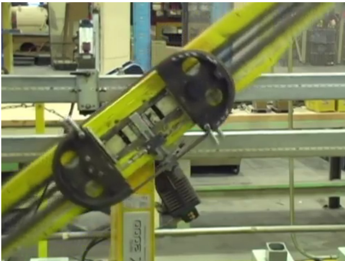
Figura 3.30. Devanadera produciendo la bobina.
