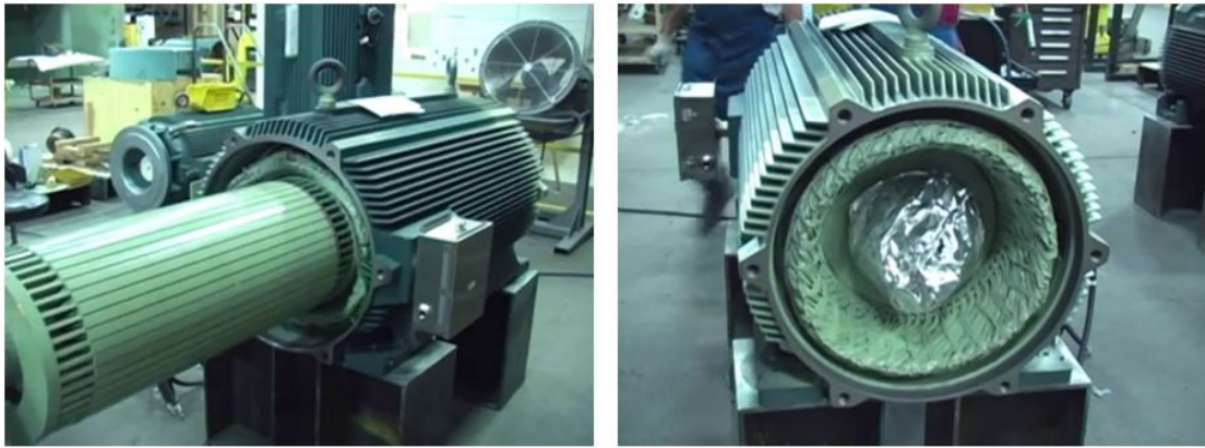
Figura 3.36. Acople de estator y rotor en carcasa.
