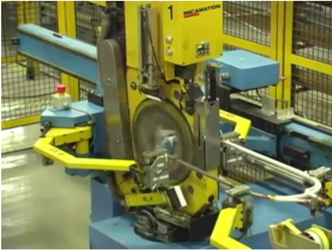
Figura 3.31. Colocación de encintado a la bobina.
