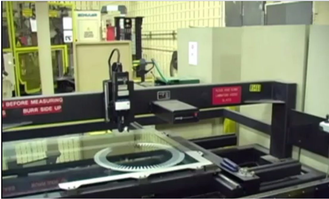
Figura 3.20. Control de calidad de una lamina de rotor o estator para su consistencia dimensional.
