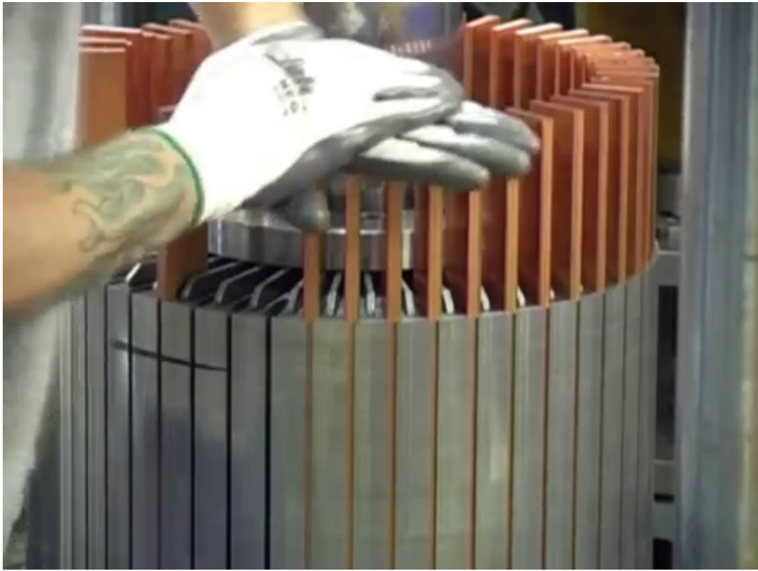
Figura 3.25. Colocación de las barras de cobre en el rotor.
