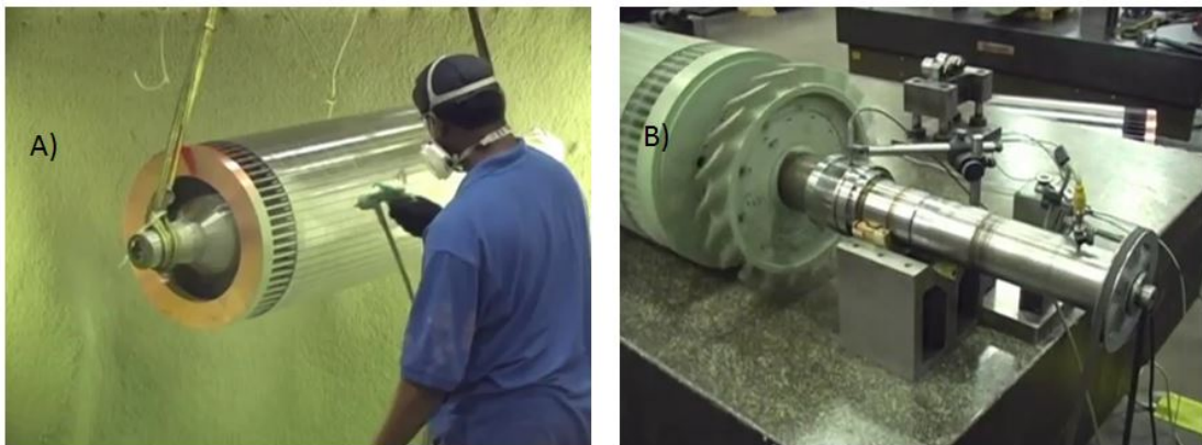
Figura 3.27. A) Aplicación de revestido de protección B) Prueba final de vibración.
