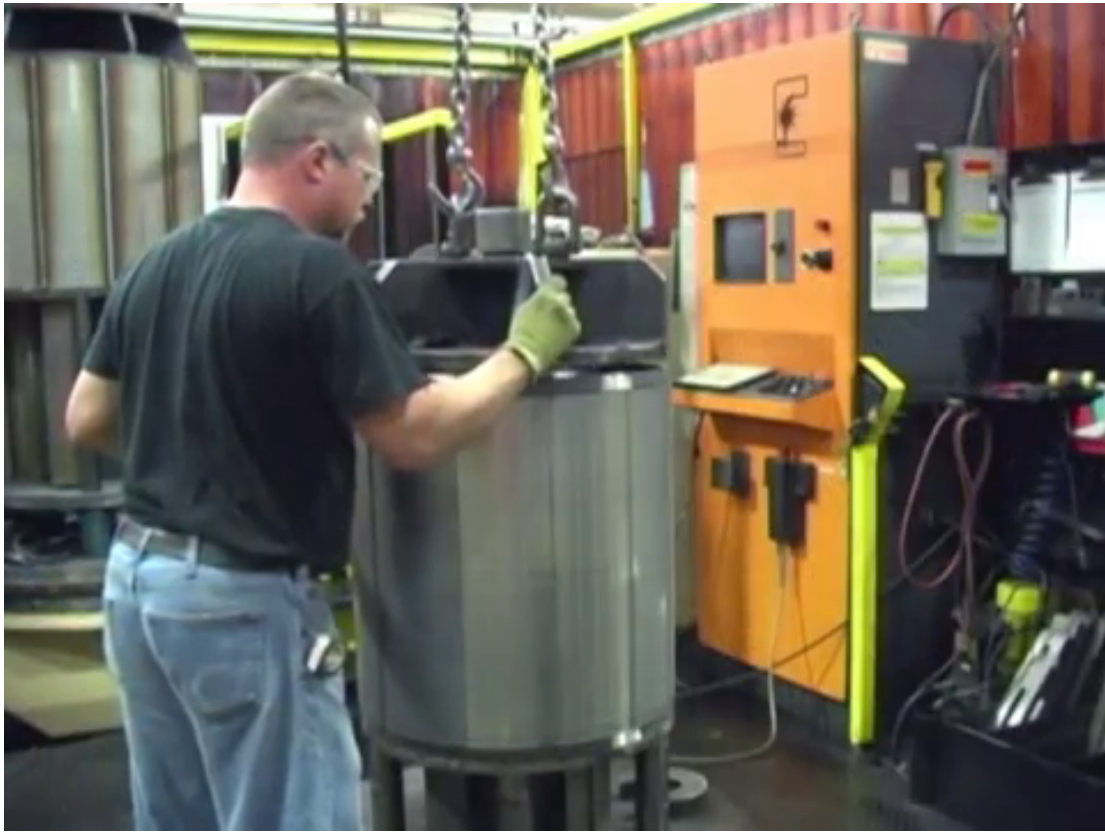
Figura 3.29. Compresión del núcleo del estator.
