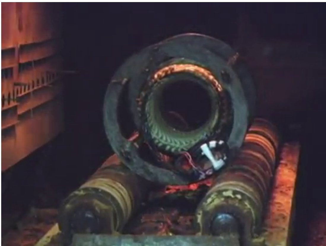
Figura 3.35. Estator en girando en horno para mejorar el proceso de barnizado.
