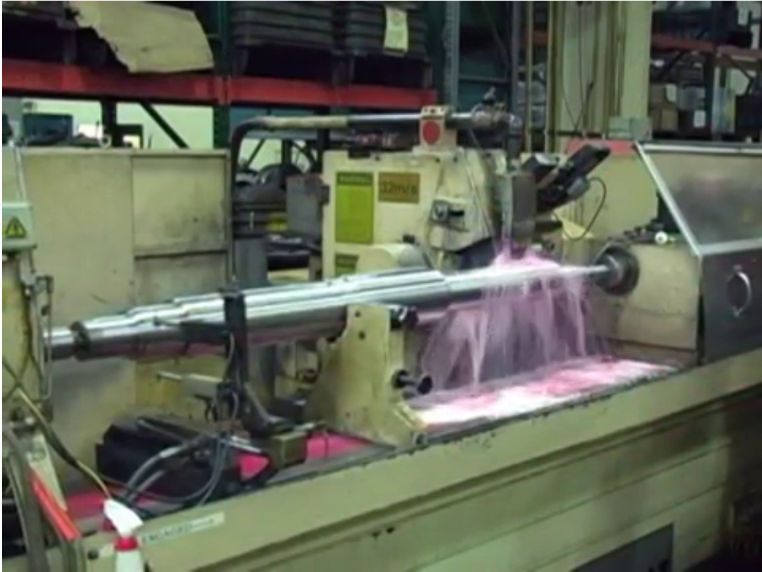
Figura 3.17. Fresadora que trabaja el rotor para su acabado final.
