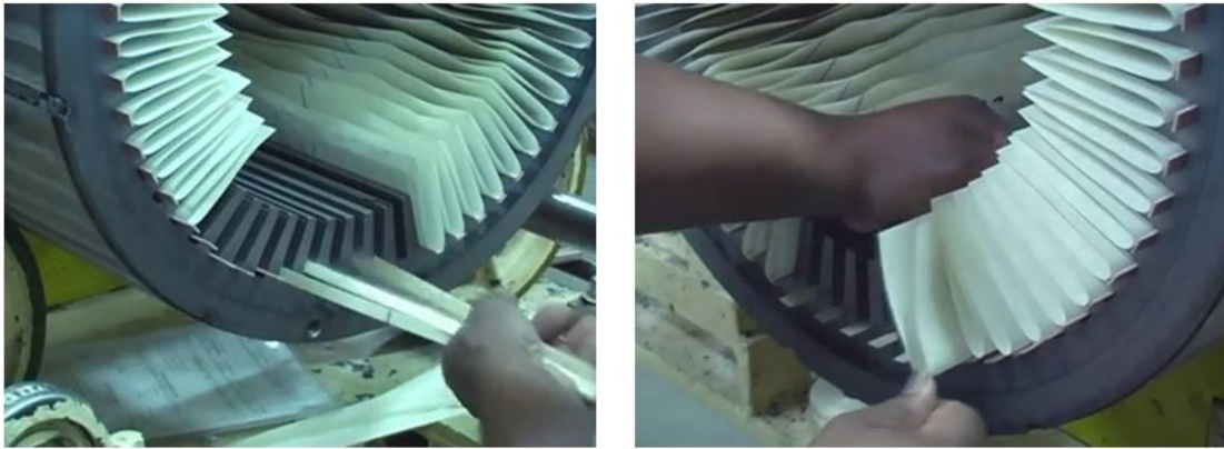
Figura 3.32. Papel aislante en el estator.
