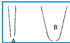
Figura 12. Forma de la punta de las pipetas utilizadas en la técnica del T.U.G.O. Patch Clamp (A). Forma de la punta de una típica pipeta pulida de Patch Clamp (B) (tomado de Romero 2004).
