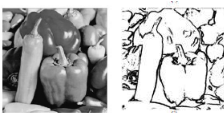
Figura 5.8 Resultados obtenidos por [27] para la detección de bordes utilizando los pseudo momentos de Zernike.
