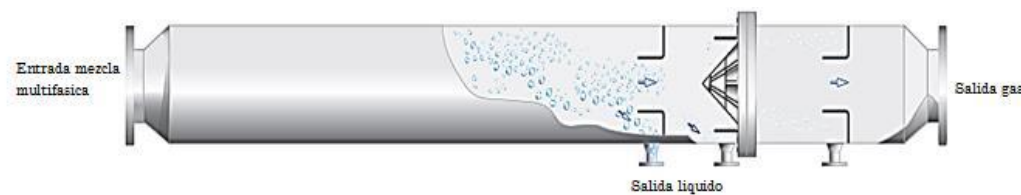
Figura 32. Azgaz - separador compacto gas-líquido en línea (Boletín N° D352002057-GEN-001, 2011).
