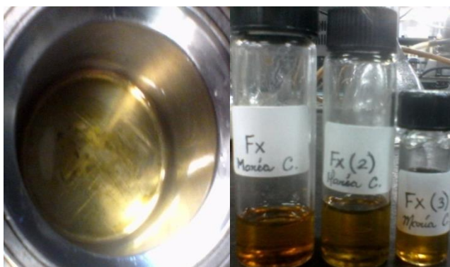
Figura 4.4. Muestra post-prueba de Capacidad de Absorción del Aditivo FX.
