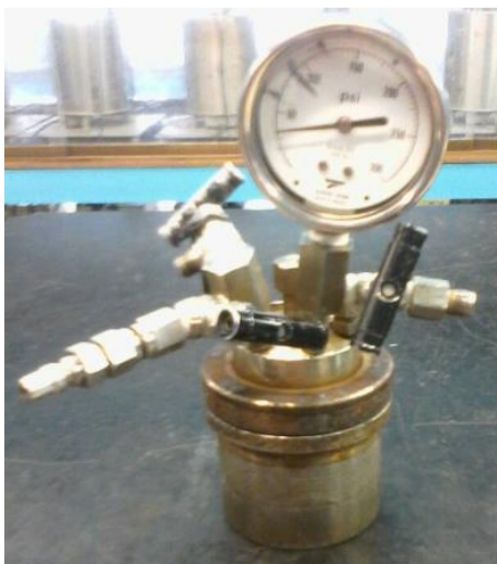
Figura 3.13. Reactor autoclave de capacidad de 100 ml.
