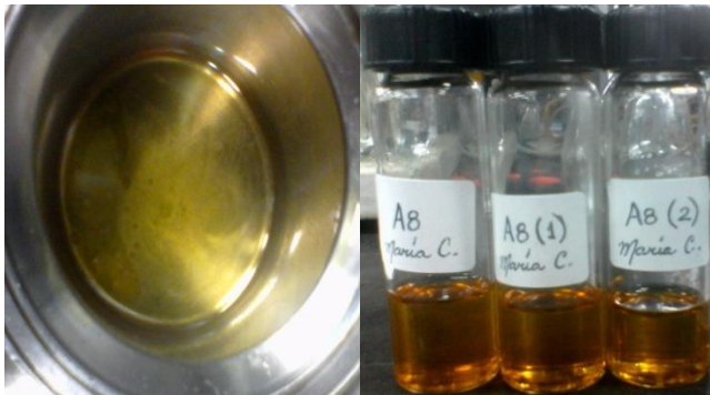
Figura 4.3. Muestra post-prueba de Capacidad de Absorción del Aditivo A8.
