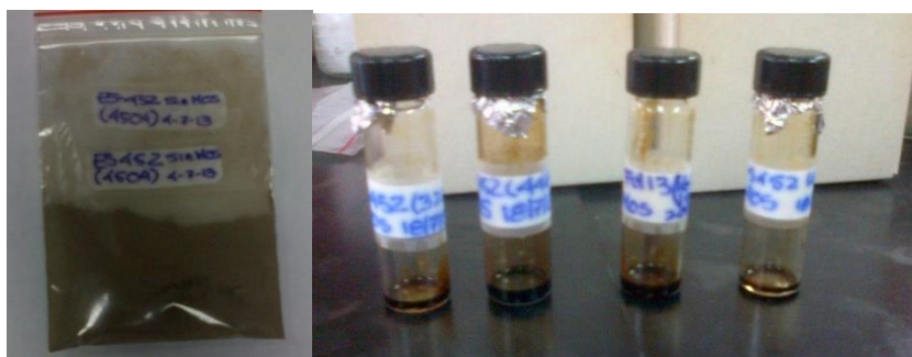
Figura 22. Muestras pulverizadas del pozo ES-452 y las muestras de MOE obtenidas a 4 profundidades.
