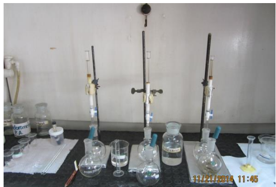
Figura 26. Fracciones de hidrocarburos saturados eluidas con n -hexano para las muestras a profundidades de 3226, 4427 y 4462 pies.
