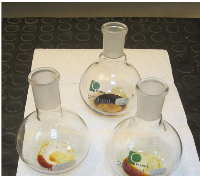
Figura 23. Materia orgánica soluble de 3 muestras seleccionadas del núcleo ES-452 (profundidades a 3226, 4427 y 4462 pies).
