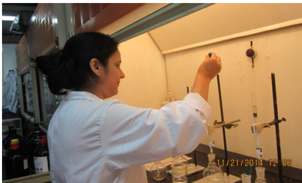
Figura 25. Separación de las fracciones SARA a través de cromatografía de adsorción en columna (profundidades 3226, 4427 y 4462 pies).
