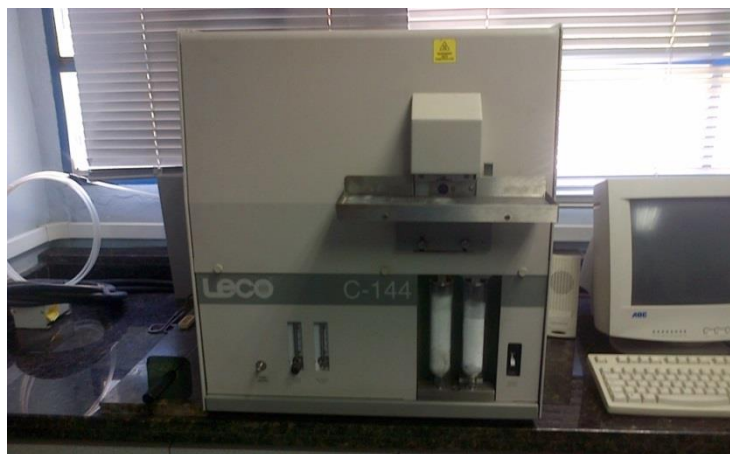
Figura 21. Equipo LECO, modelo C-144 para la obtención de carbono total.
