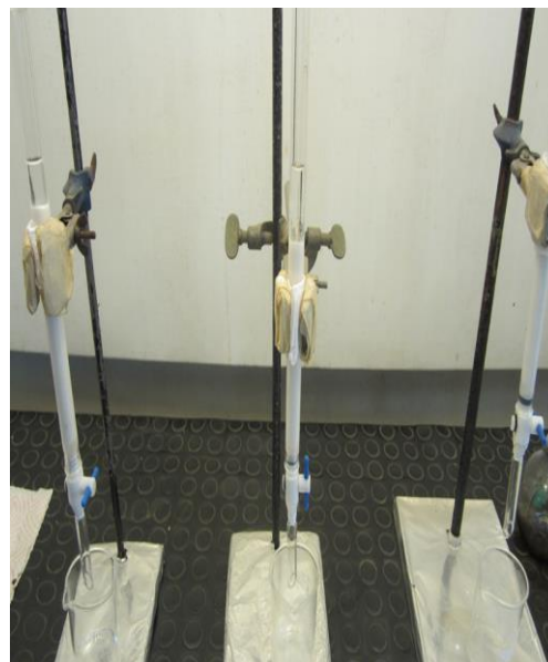
Figura 24. Cromatografía de adsorción en columna para 3 muestras seleccionadas del núcleo ES-452 (profundidades a 3226, 4427 y 4462 pies).
