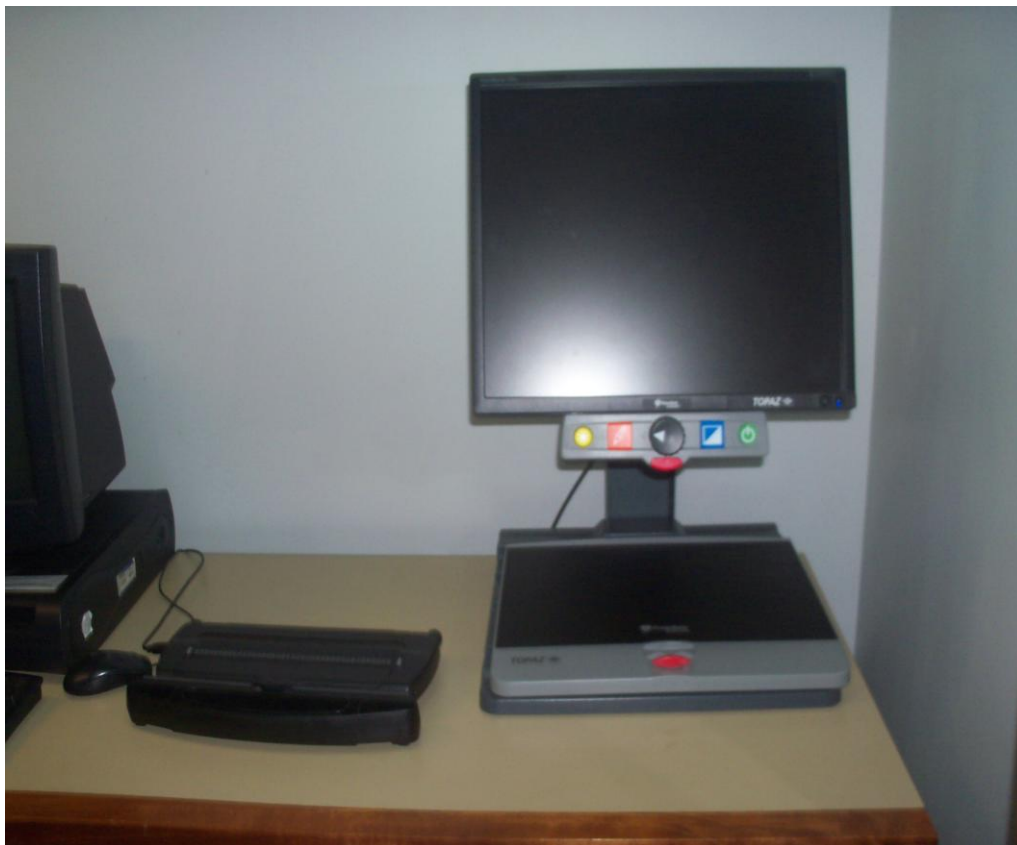
Figura 15.- Circuito magnificador de imágenes.
