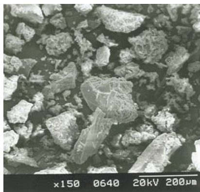
Figura 59. Micrografías (MEB) de las alúminas sintetizadas con el templante lactosa.
