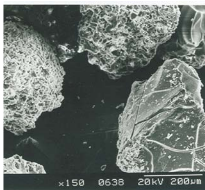
Figura 58. Micrografías (MEB) de las alúminas sintetizadas con el templante glucosa.
