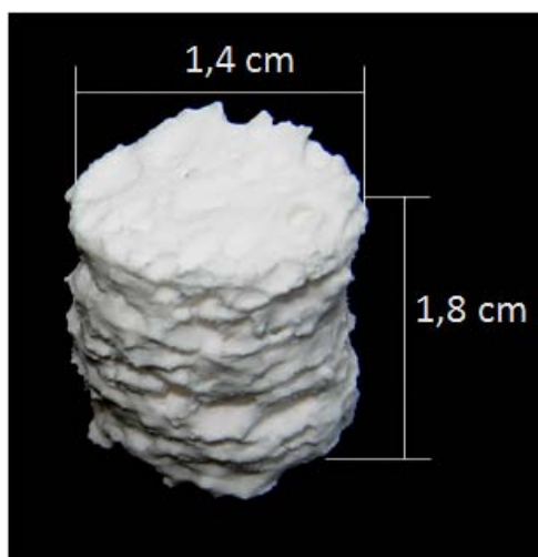
Figura 14. Fotografía de la espuma cerámica preparada con el poliuretano C y la \gamma -alúmina sintetizada.
