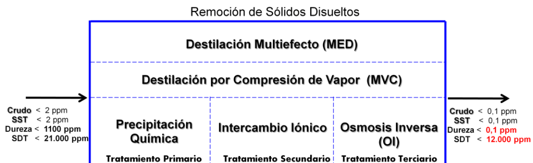
Figura N° 12. Tecnologías aplicables para el proceso de remoción de sólidos totales
