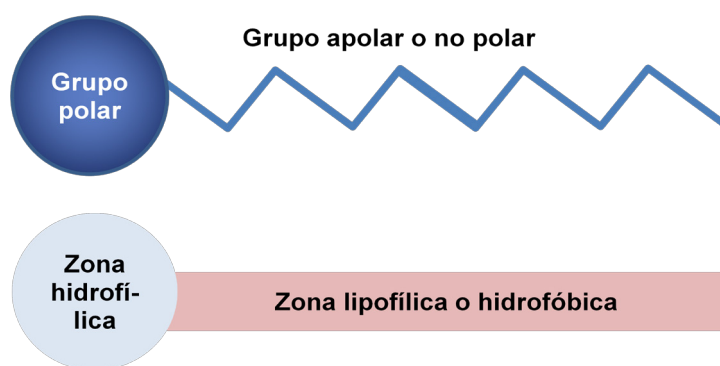
Figura 8. Representación esquemática de la estructura típica de un surfactante.
