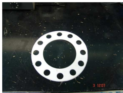
Figura N° 27. Sello de la tapa del Saturador TK-01
