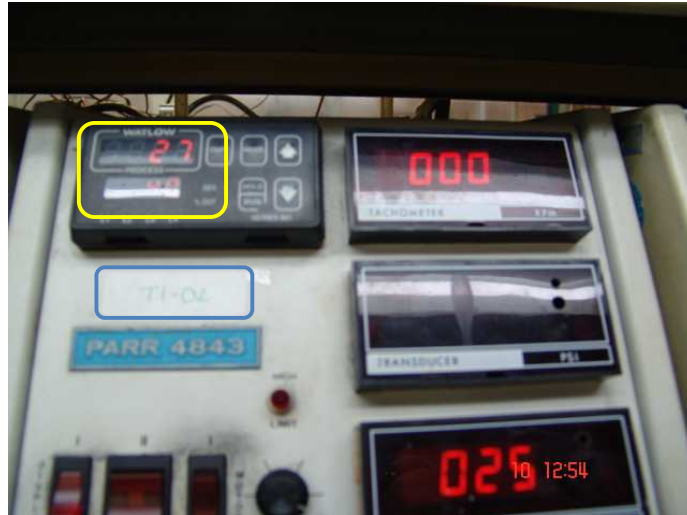
Figura N° 20. Prueba de continuidad y desempeño de la estación TIC TI-02
