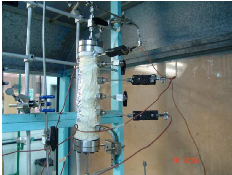
Figura N° 18. Termopares del Reactor conectados a las Estaciones TIC
