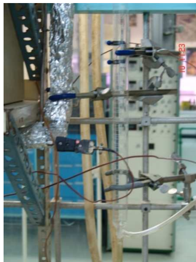
Figura N° 21. Termopar instalado en la tubería, aislada térmicamente, entre el saturador y el separador S-01.
