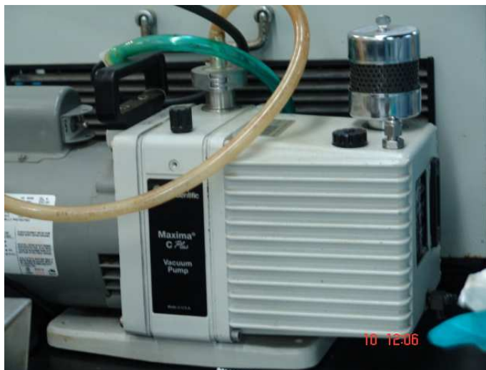
Figura N° 37. Bomba de Vacío, Máxima C plus modelo M8C
