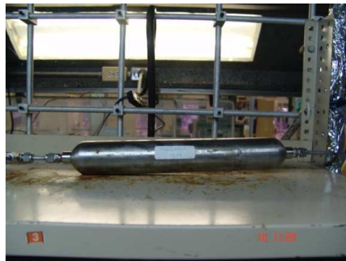
Figura N° 24. Mezclador M-01 instalado en la planta
