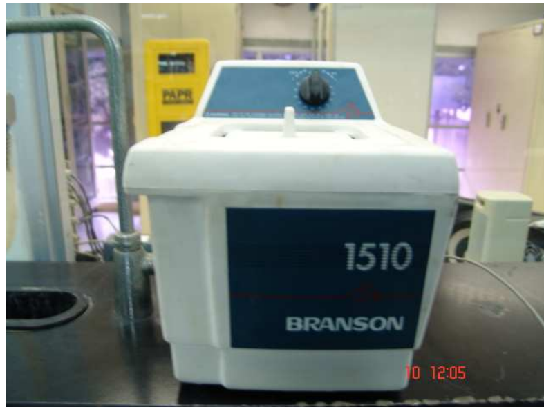
Figura N° 6. Equipo utilizado para la limpieza por Ultrasonido.
