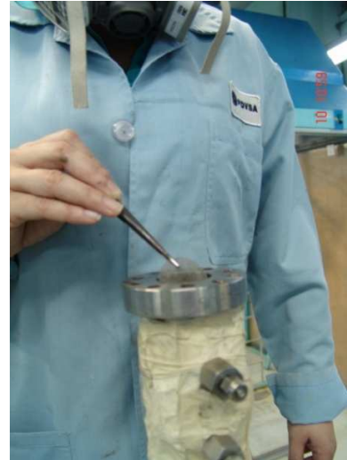
Figura N° 44. Rejillas metálicas que mantenían en su posición a los lechos dentro del reactor
