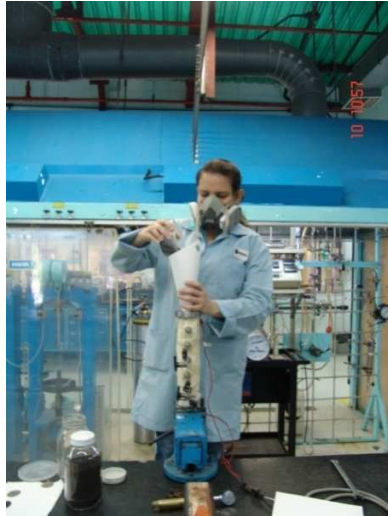
Figura N° 43. Introducción de los lechos en el Reactor
