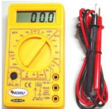
Figura N° 8. Multímetro para verificar continuidad eléctrica
