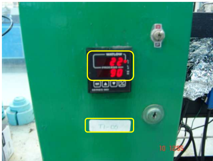
Figura N° 22. Prueba de continuidad y desempeño de la estación TIC TI-05
