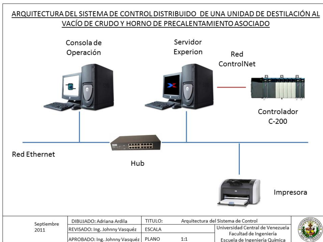
Figura N° 25 – Arquitectura del sistema de control (Elaboración Propia)
