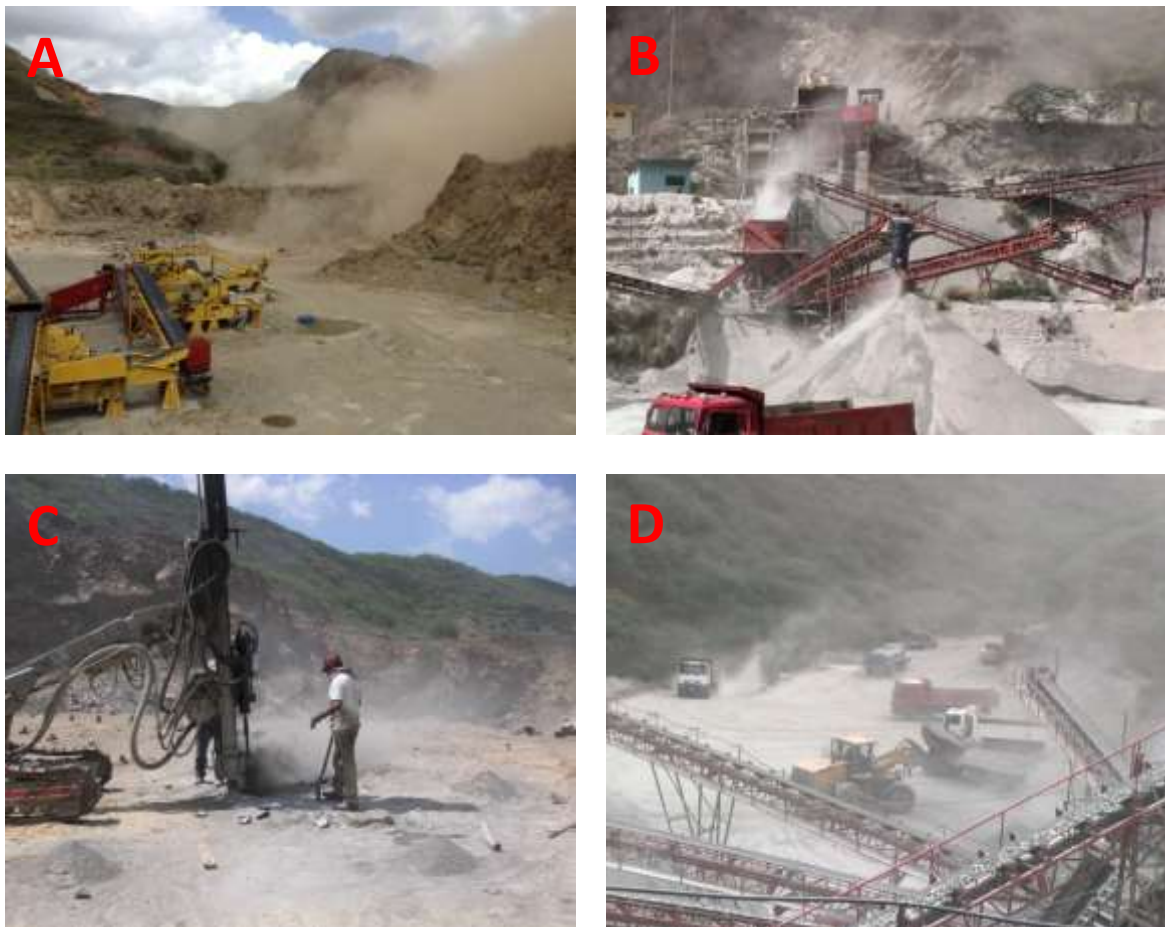
Figura N° 29. Emisiones de PTS en la Cantera Carayaca: (A) voladura (B) Planta 1 (C) perforación (D) equipos
