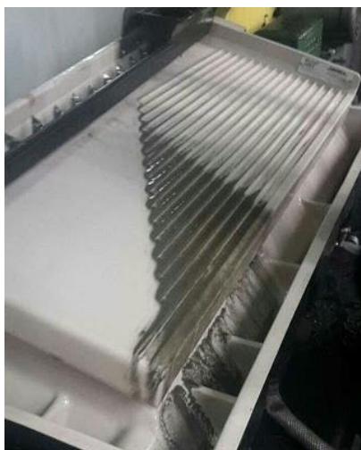
Figura 14. Concentración de minerales mediante el empleo de la Mesa Wilfley.
