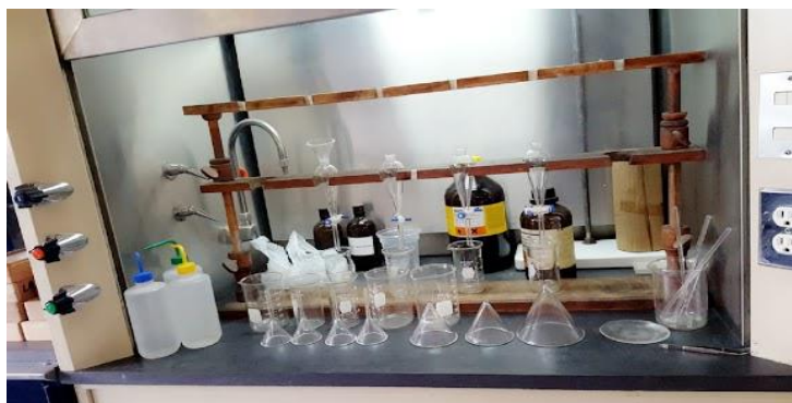
Figura 16. Material utilizado para la separación de minerales pesados y livianos con el Bromoformo
