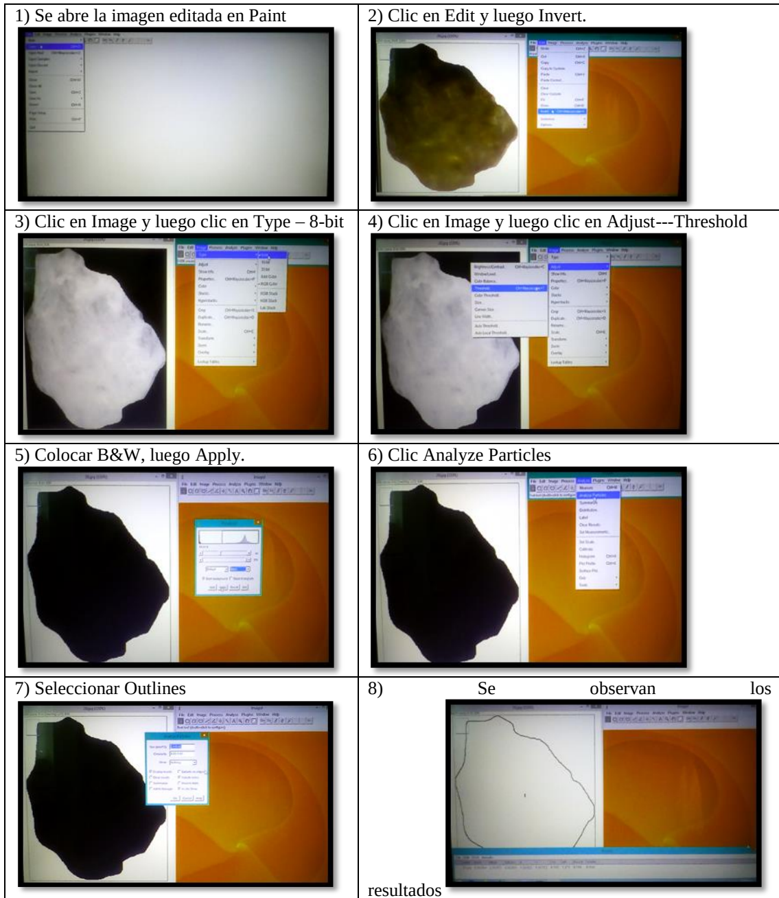
Figura 23. Procedimiento aplicado en cada grano, mediante el programa Image J, para la obtención de los valores de redondez y esfericidad.
