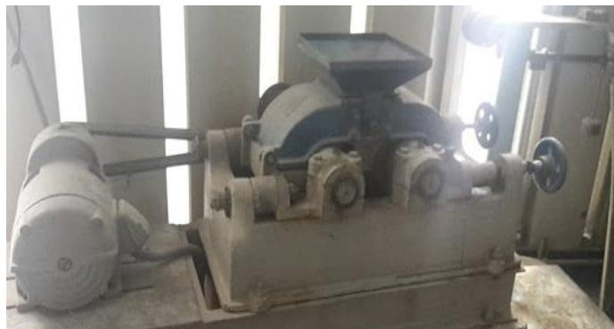
Figura 12. Procesamiento de Muestras mediante una Trituradora de Cilindros.
