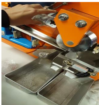
Figura 15. Procesamiento de la muestra mediante el Separador Magnético Magnet Lift. Laboratorio de Termocronología UCV.
