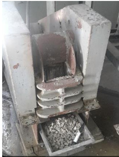
Figura 11. Procesamiento de Muestras mediante una Trituradora de Mandíbulas.
