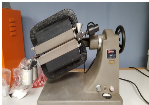
Figura 20. Separador Isodinámico Frantz. Laboratorio de Termocronología. UCV.
