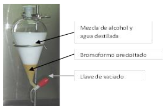
Figura 19. Precipitación del alcohol absoluto en agua destilada y separación por densidad del bromoformo o tetrabromuro. (Tomado de Martínez y Materano, 2016).
