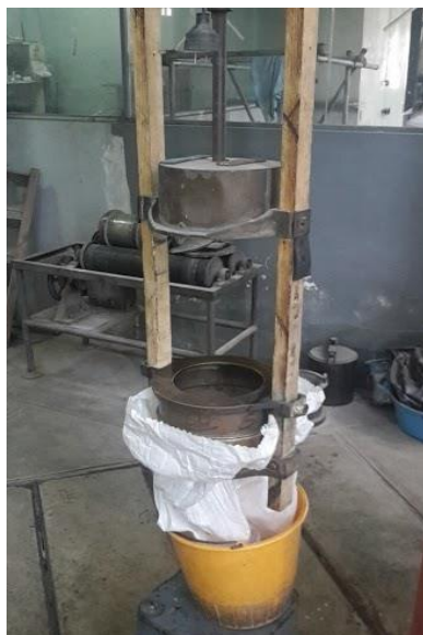
Figura 13. Tratamiento de muestras mediante una Tamizadora.
