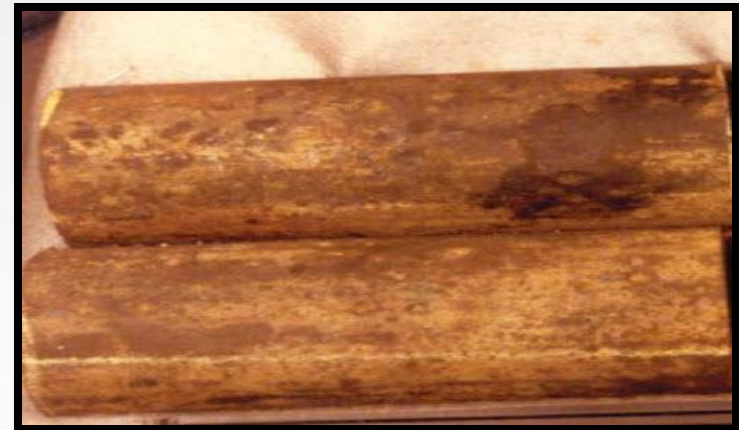
Corrosión uniforme por \text{H}_2\text{S}
