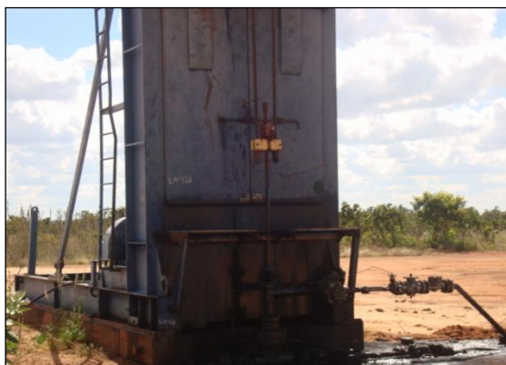
Figura N° 29 Unidad Rotaflex del pozo LM-416
