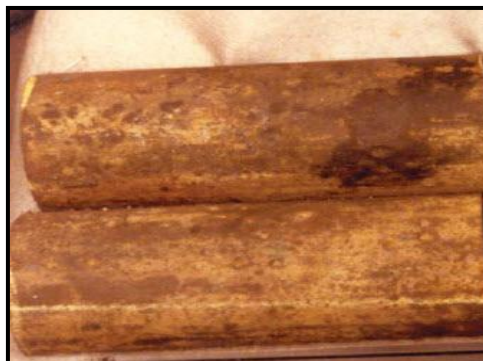
Figura N° 11 Corrosión general o uniforme por H_2S . Fuente: Nalco
