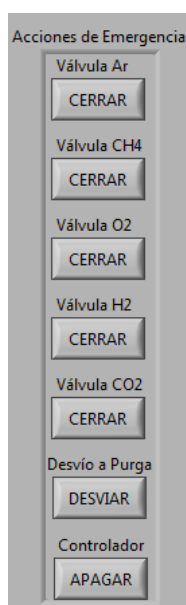
Figura N° 31. Panel de Acciones de Emergencias
