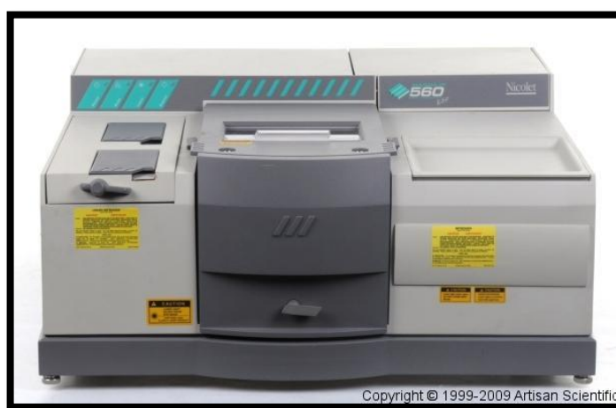
Figura N°III.3. Espectrómetro Marca Nicolet Modelo MAGNA 560.
