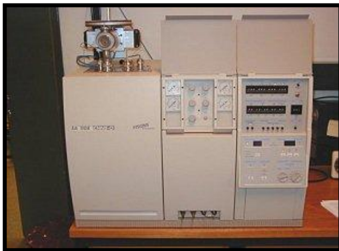
Figura N°III.8. Equipo empleado para la determinación del C, H y N presente en los precursores y catalizadores sintetizados.
