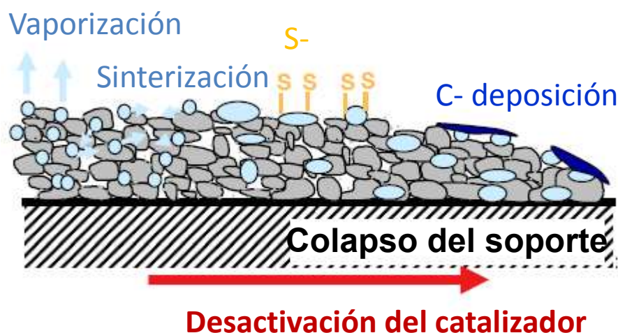
Figura 18. Etapas de desactivación de un catalizador de reformado de HC.
