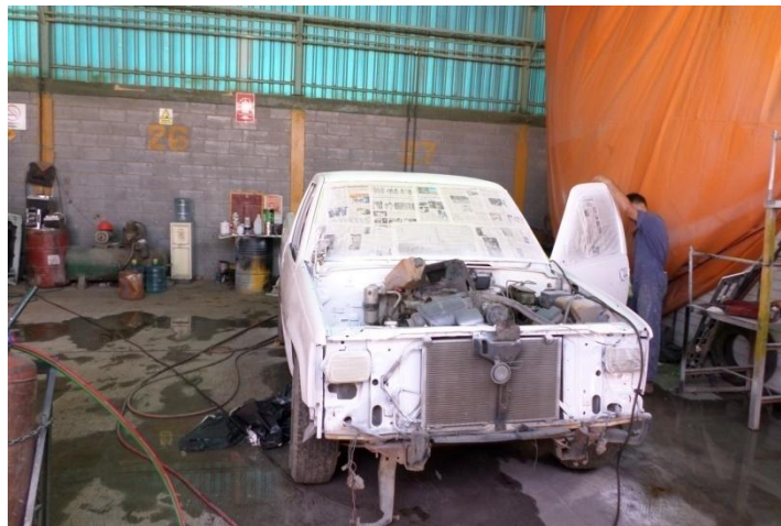
Figura 6. Desarme y protección
