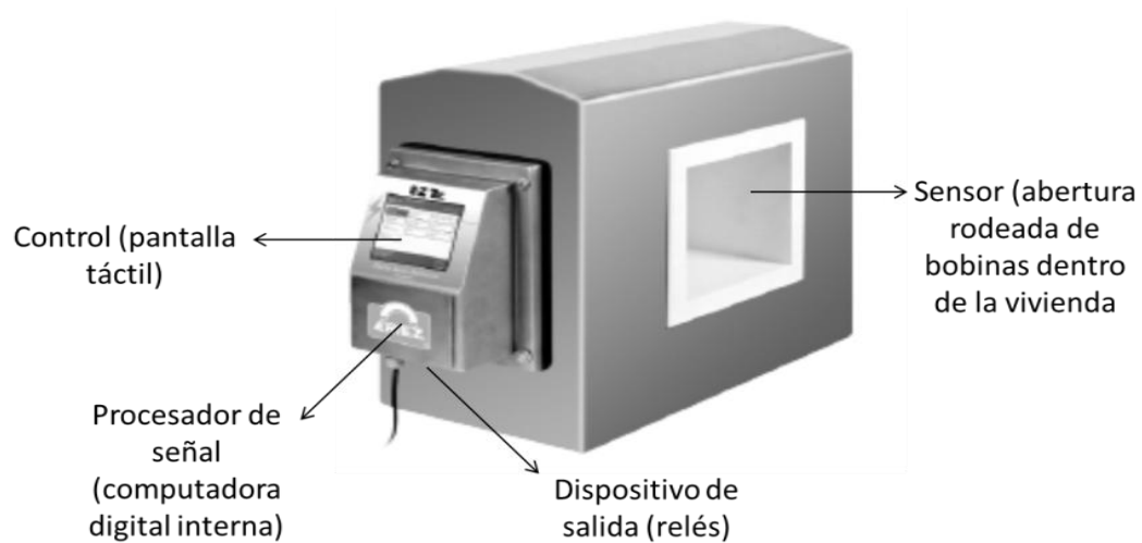
Figura 17. Partes del sistema de detección de metales. Fuente: Milagros Rodríguez (2016).
