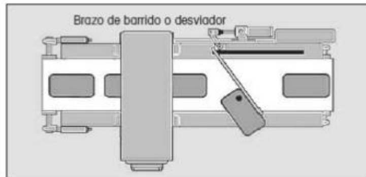
Figura 11. Ejemplo de sistema de rechazo por barro de barrido o desviador. Fuente: Mettler Toledo (2008).
