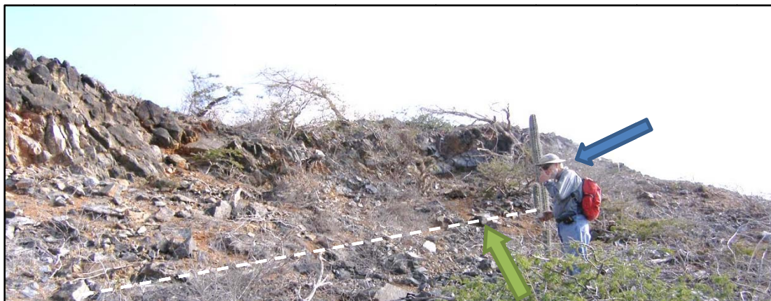
Figura 10. Zona oriental del cuerpo de cromitita masiva. La flecha azul muestra la localización del muestreo PP2, la flecha verde indica la de los muestreos PP3 y PP4 y la línea segmentada blanca el contacto inferior de la cromitita con la roca encajante. Orientación norte-sur.
